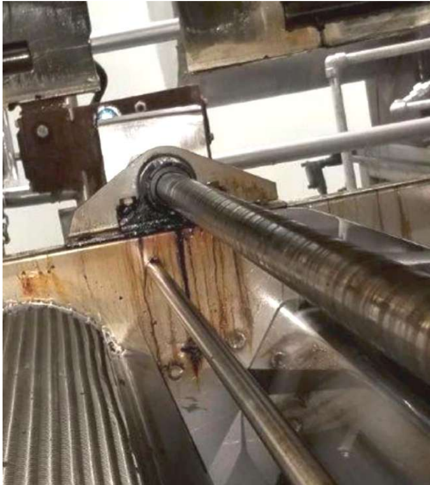
Image 2 - Le palier à semelle Graphalloy se trouve à l'extrémité de l'arbre, dans la friteuse
